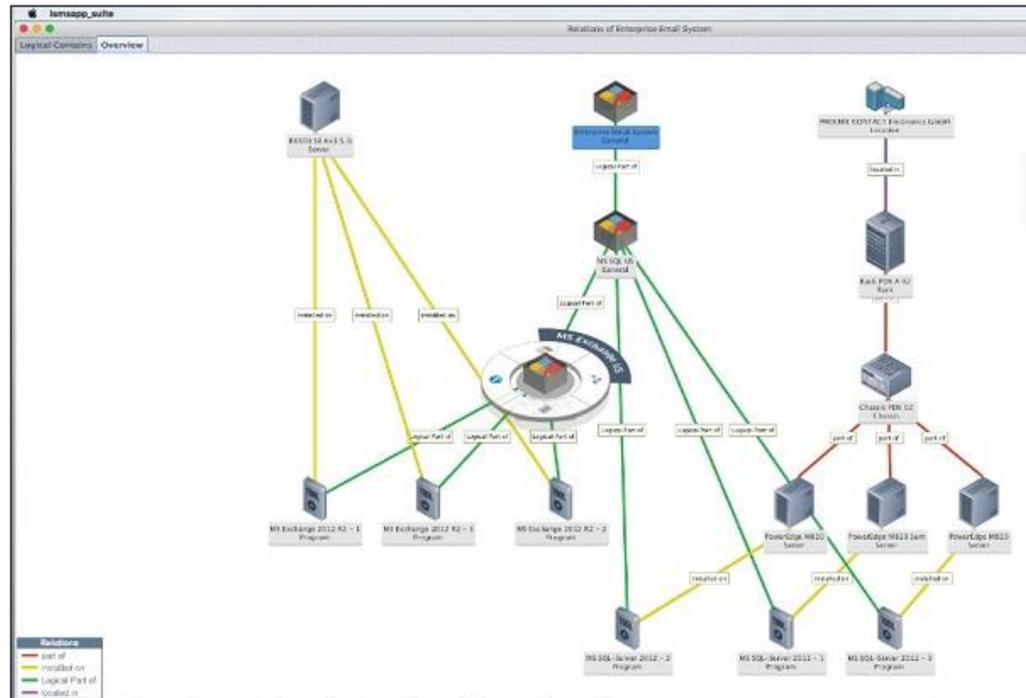
Auconet Relationship Mapping unterscheidet vier vordefinierte Arten von Beziehungen: Inside, Contains und Uplink, sowie Installed on. Zum Beispiel: Switches sind INSIDE einer Schieneneinheit und Racks enthalten (CONTAIN) Server.
